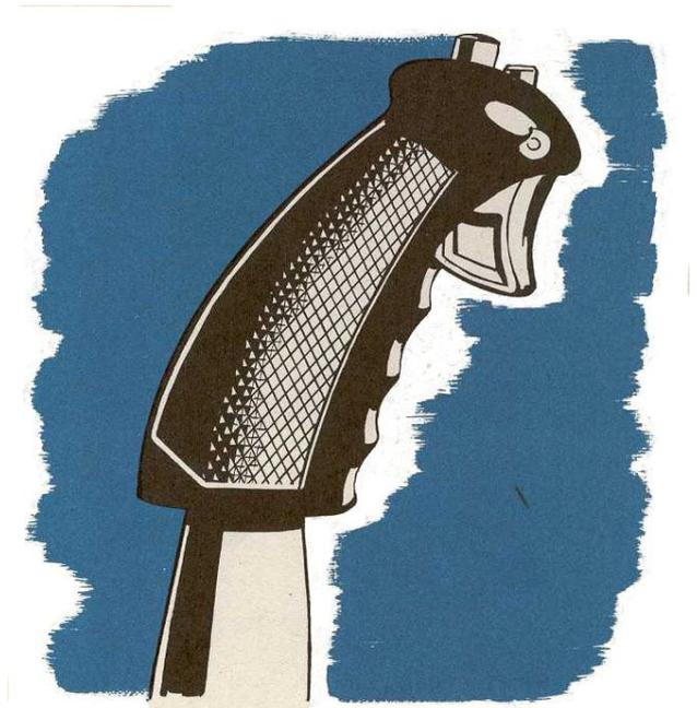
de alerones en la parte frontal superior, el mando del compensador de timón en la parte posterior superior y el mando del compensador de profundidad en el lateral derecho.
