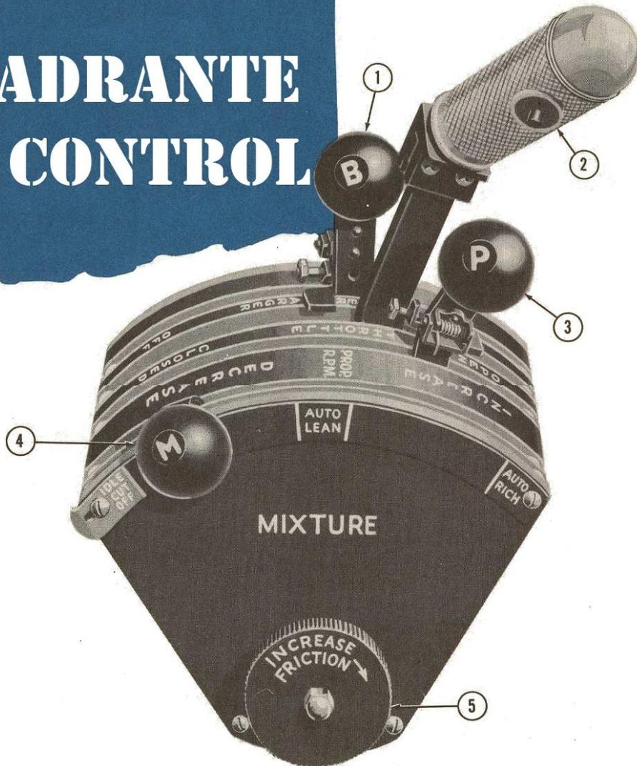
1. Mando del turbocompresor (anulado - automático)
